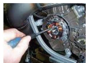
Retirez les trois vis de fixation du stator avec un tournevis cruciforme.
