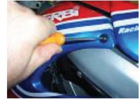
Retirez les deux vis supérieures des flans de radiateur droit et gauche avec un tournevis cruciforme.
