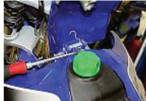
Retirez la vis support du cache réservoir avec un tournevis cruciforme.
