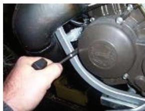
Repositionnez les trois vis de fixation du carter d'allumage DOPPLER avec une clé à pipe de 8.
