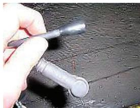
Récupérez le câble haute tension d'origine et placez dessus la protection anti-humidité fournie avec la bobine haute tension DOPPLER.
