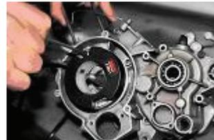
Récupérez le passe fil du stator d'origine et le positionner dans le bon sens sur la gaine du stator DOPPLER. Présentez le stator Premium sur la platine en passant la gaine par le trou du carter et le serrer avec les deux vis 5x30 fournies.
