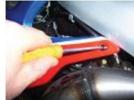
Retirez les deux vis inférieures des flans de radiateur droit et gauche avec un tournevis cruciforme.
