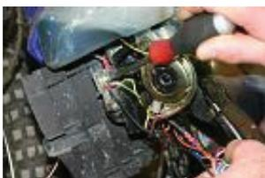
Positionnez la bobine haute tension à son emplacement d'origine en fixant à la masse le câble noir du diagramme et le câble vert/jaune du stator.
