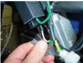
Retirez le câble de la bobine haute tension et déconnectez le connecteur deux voies blanc reliant le stator d'origine au faisceau.
