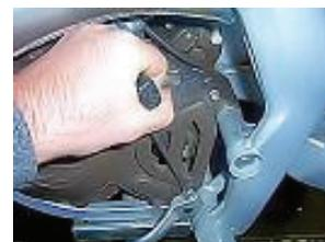
Repositionnez avec une clé à pipe de 10 la vis de fixation du sélecteur.
