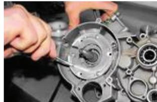
Présentez la platine DOPPLER et la serrer avec trois vis fournies avec un tournevis cruciforme.
